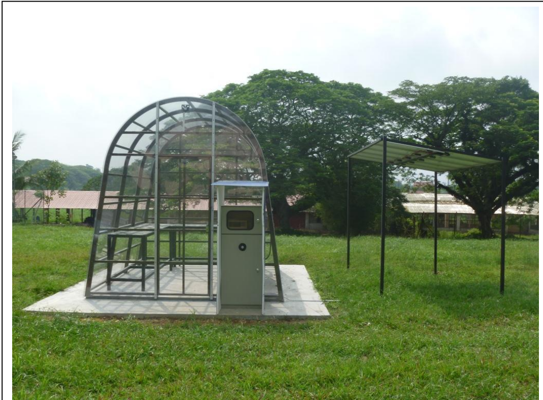
Gambar 3: Sistem pengeringan solar rumah hijau
